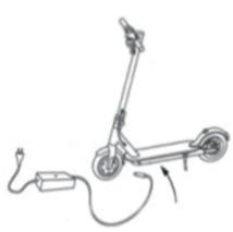
Перед первым использованием самоката полностью зарядите аккумулятор. Откройте резиновую крышку зарядного порта в нижней части самоката и вставьте выходной разъем зарядного устройства в зарядный порт. Вставьте вилку в розетку. Если индикатор зарядного устройства красный, это означает, что аккумулятор заряжается. Если он становится зеленым, это означает, что аккумулятор полностью заряжен.
